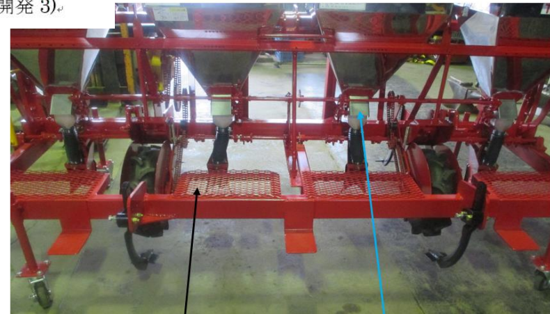
肥料投入時足場
